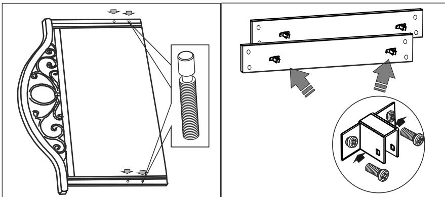
В гайки стоевых брусков головной спинки поз 01 на 2-3 оборота ввернуть винты стяжки. Царги поз 03 оборудовать цокольной кроватной стяжкой при помощи винтов 6.3x16.
