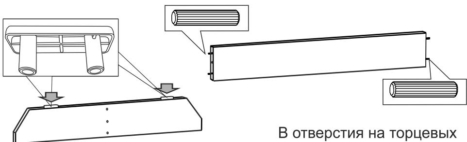
В отверстия на кромке опорных стенок поз.04 установить наконечники.
