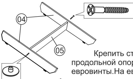
Крепить стенки опорные поз.04 к стенке продольной опорной поз.05 на шканты и евровинты. На евровинты установить заглушки.
