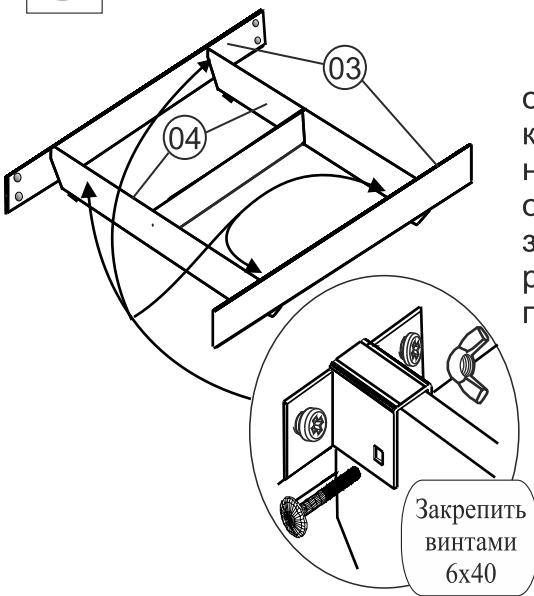
Царги поз.03, предварительно оборудованные цокольной кроватной стяжкой, установить на собранную конструкцию из опорных стенок поз. 04 и закрепить, как показано на рисунке, винтами 6x40 при помощи барацковой гайки.
